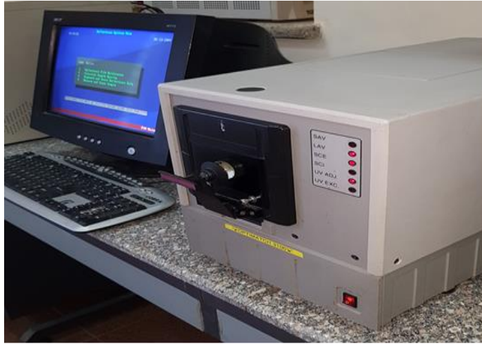
( لوحة ٣ ) توضح جهاز التغير اللوني المستخدم في القياس لعينات اللواصق ١
