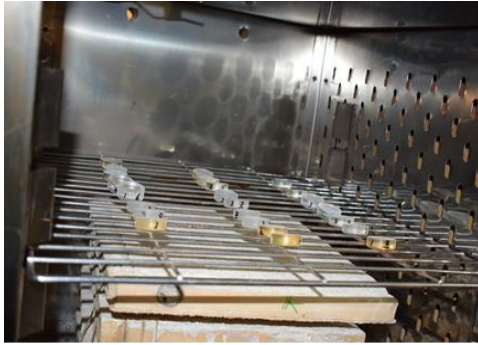
لوحة ١: توضح عينات اللواصق داخل فرن التقادم الحراري
