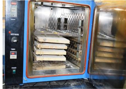
لوحة ١: توضح عينات اللواصق داخل فرن التقادم الحراري
